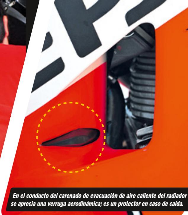
En el conducto del carenado de evacuación de aire caliente del radiador se aprecia una verruga aerodinámica; es un protector en caso de caída.
