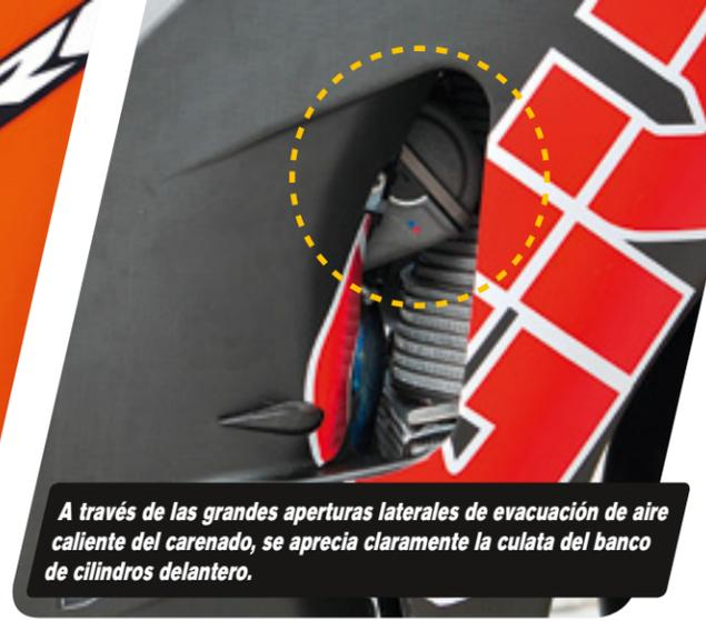
A través de las grandes aperturas laterales de evacuación de aire caliente del carenado, se aprecia claramente la culata del banco de cilindros delantero.
